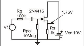
La figure ci contre représente un étage suiveur utilisant un JFET classique le 2N4416 .On notera sur les courbes ci dessus le gain qui dépasse à peine 0,7 et la chute brutale de l'impédance d'entrée à partir de 50kHz.
