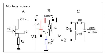
Les montages A et B sont en pratique de peu d'intérêt car le gain est faible, le plus souvent quelques unités seulement. Le montage le plus utilisé est le montage suiveur ou drain commun représenté en A ci contre . En BF ce montage à une impédance d'entrée très élevée sinon infinie ( courant de grille nul ou en pratique de quelques pico Ampére ) une
