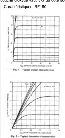
plus faible coté drain , la concentration des porteurs y est donc plus faible. Le phénomène est analogue à celui qui a été constaté pour les JFETs , le canal est pincé à droite, mais il s'agit ici d'un effet de concentration de porteurs et non un effet géométrique.
