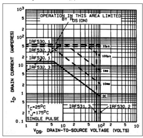
La figure ci contre représente les limites de dissipation thermique d'un MOS de puissance type IRF530 de International Rectifier. En régime continu pour une tension drain de 10V le courant maximal admissible est de 8A , soit une puissance de 80W (à 25° boitier ) .Pour 100V courant est de 0,8V ce qui correspond à la même puissance. Les MOS ne sont pas sujets au second claquage Ces montrent courbes que une pour impulsion de 1mS le courant avec 100V drain peut atteindre 7A.
