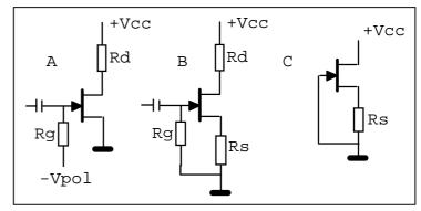
Le montage C est une **source de courant**, le courant drain est indépendant de la tension drain tant que  $V_{DS}$  est supérieure à une valeur minimale qui est de l'ordre de  $|V_P|$ .
