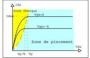
tension grille source (en jaune sur la figure ) et une zone de pincement ou le courant est presque indépendant de la tension drain (résistance interne très grande ), (en bleu pâle sur la figure ).
