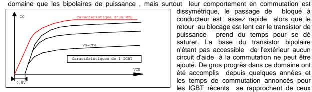
dissymétrique, le passage de bloqué à conducteur est assez rapide alors que le retour au blocage est lent car le transistor de puissance prend du temps pour se dé saturer. La base du transistor bipolaire n'étant pas accessible de l'extérieur aucun circuit d'aide à la commutation ne peut être ajouté. De gros progrès dans ce domaine ont été accomplis depuis quelques années et les temps de commutation annoncés pour les IGBT récents se rapprochent de ceux
