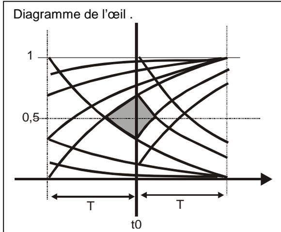
Avec une constante de temps voisine de la période bit , la figure obtenue est reproduite ci contre . Les tracés successifs couvrent l'écran sauf au centre .A l'instant  $t_0$  , fin de période le niveau est supérieur à 0,5V si le symbole précédent était un 1 , inférieur à cette même limite si c'était un zéro. L'identification n'est possible que si la zone centrale , remplie en grisé sur la figure ,subsiste. On dit que l'œil est ouvert.
