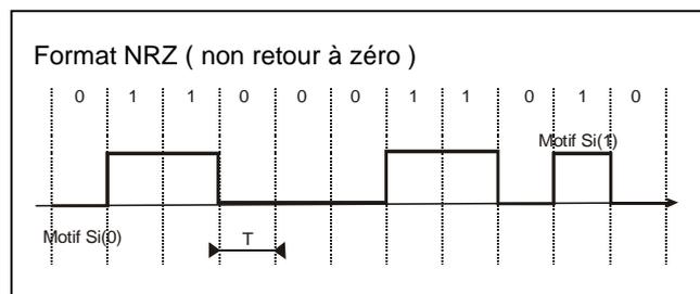
raie à la fréquence bit en effet le produit du signal NRZ et d'une sinusoïde à la fréquence de l'horloge bit à une moyenne nulle. A la réception la restitution de cette horloge risque donc d'être difficile .
