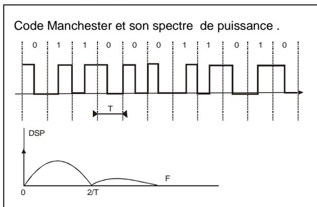
s de largeur  $T/2$ , son spectre présente donc une largeur (du premier lobe )  $2/T$  double de celui du NRZ de base. Par contre sa densité spectrale de puissance est nulle à la fréquence zéro, il n'y a pas de raies ce qui complique la restitution de l'horloge bit au niveau du récepteur .
