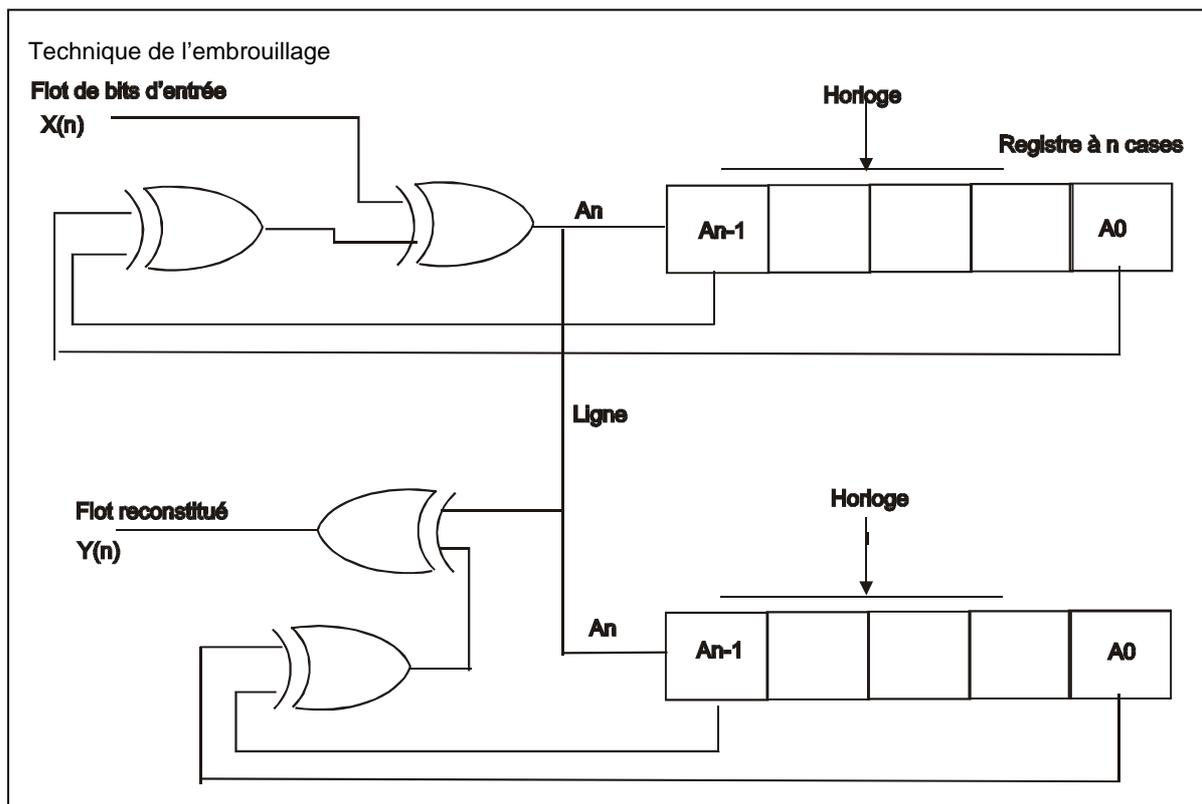
séquence pseudo aléatoire par le flot de bits à transmettre. Le résultat est une suite possédant de nombreuses transitions. Le signal initial est restitué au niveau du récepteur grâce à un circuit identique à celui utilisé à l'émission.
