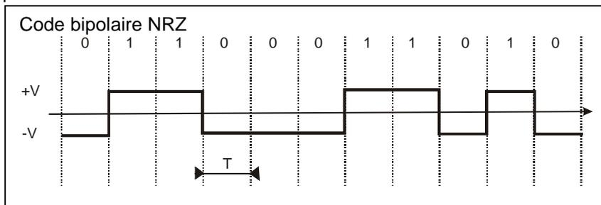
Ce code est utilisé par exemple pour les liaisons type RS232 entre ordinateurs, il présente l'avantage de distinguer un niveau valable d'une rupture de liaison (qui donne un niveau nul). Le spectre de ce signal a comme largeur  $1/T$  et ne
