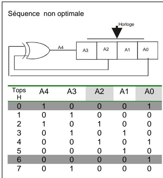
Avec le bouclage de la figure de gauche l'état initial du registre à décalage se retrouve après 6 tops d'horloge , le signal recueilli sur l'un des étages , par exemple le dernier  $a_0$  , à comme période 6 .
