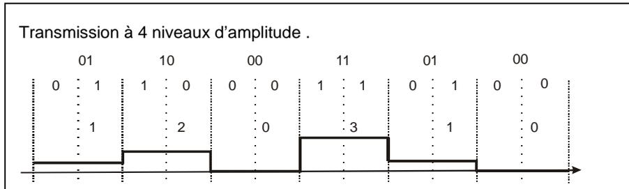
Avec 8 niveaux les bits doivent être groupés par 3 , par rapport à un code NRZ le débit pour une même fréquence d'horloge est triplé .Mais la reconnaissance sans erreur d'un niveau parmi 8 est délicat et
